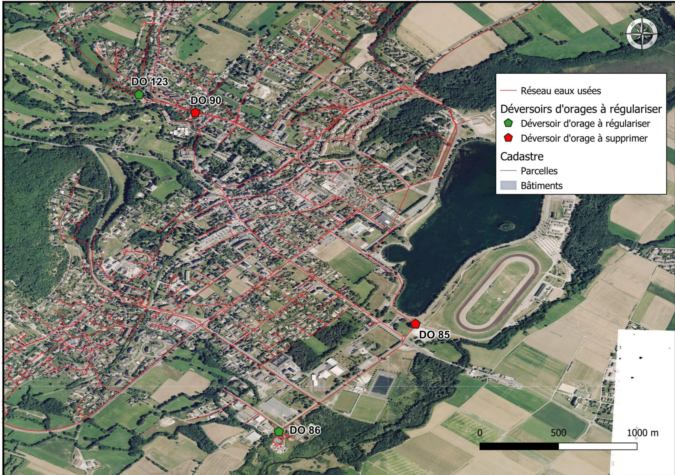
Figure 2 : Plan de situation des déversoirs d'orage à régulariser et à supprimer de la zone d'étude à l'échelle 1/25 000 (Source : Suez Consulting)
